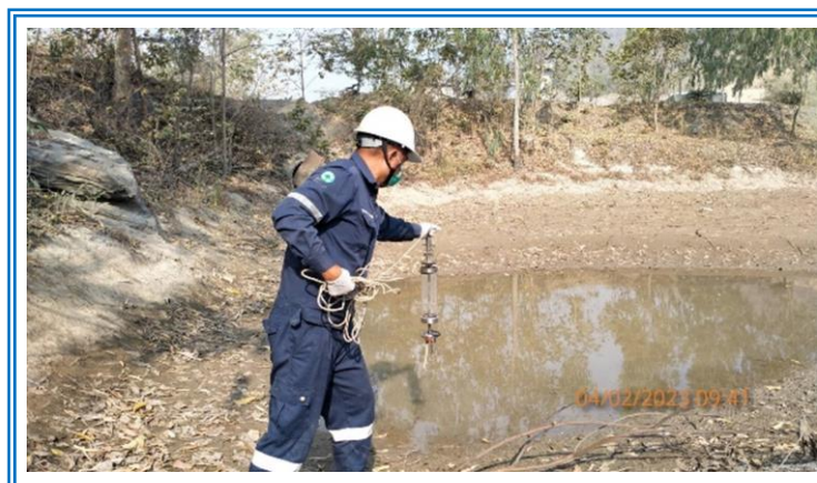
รูปที่ 4.3-12 แสดงการเก็บตัวอย่างเพื่อตรวจวิเคราะห์คุณภาพน้ำผิวดิน บริเวณบ่อดักตะกอนของโครงการ วันที่ 4 กุมภาพันธ์ 2566
