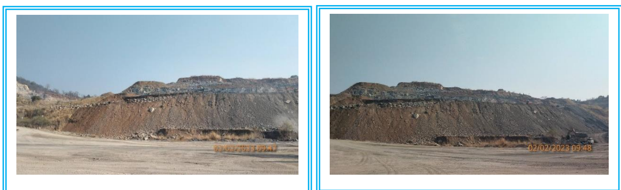
รูปที่ 2.4-1 เหมืองแบบชันบันได
