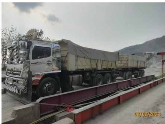
รูปที่ 3-10 การปิดคลุมรถบรรทุกด้วยผ้าใบมิดชิด
