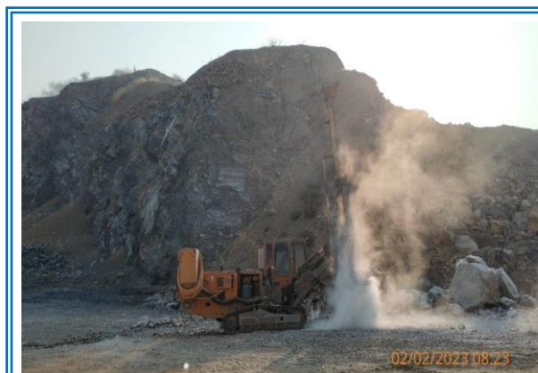
รูปที่ 3-5 เครื่องเจาะระเบิดที่มีอุปกรณ์เก็บฝุ่น ติดไว้กับหัวเจาะ
